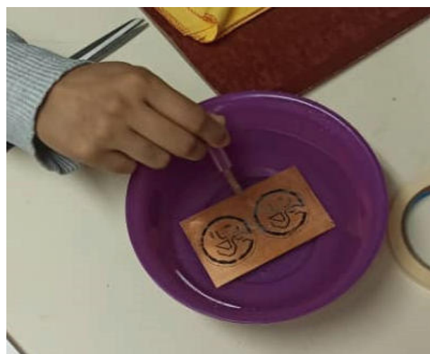
Figura 9. Limpieza de la baquelita luego del tratamiento con ácido
