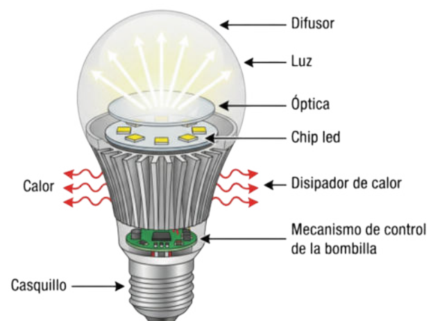
Figura 1. Principios operativos de un bombillo LED comercial.
