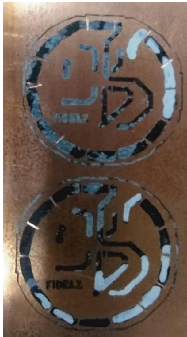
Figura 8. Pistas del circuito rectificadas
